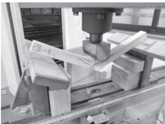
写真-2 曲げ試験, 破壊した状態
